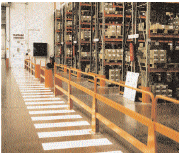
Allée piétonne protégée et matérialisée.
